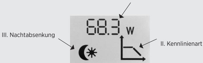
I. Anzeige der augenblicklich aufgenommenen elektrischen Leistung im Wechsel mit der momentan eingestellten Förderhöhe der Pumpe.
